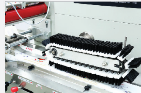
Βούρτσα συγκράτησης για συσκευασία πολλαπλών προϊόντα με μικρή επιφάνεια βάσης ή σφαιρικά σχήματα
