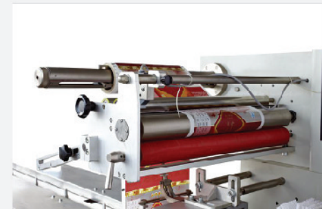
Επιπλέον προωθητικός κύλινδρος για αποφυγή προβλημάτων στον οδηγό διαμόρφωσης του film
