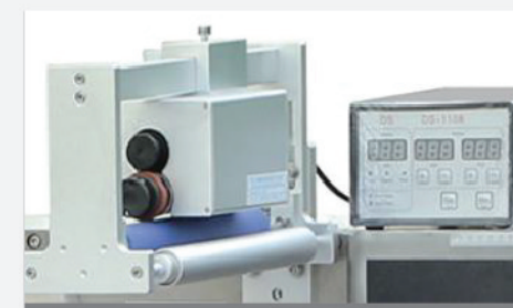
Ενσωματωμένος εκτυπωτής ψηφίων για ημερομηνία και lot number
