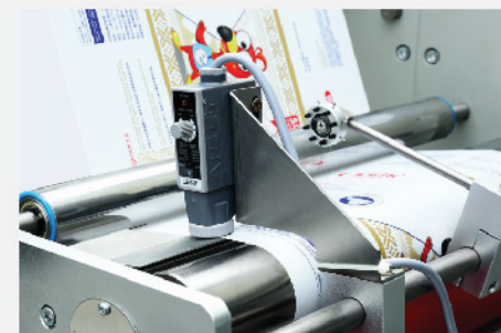
Φωτοκύτταρο για στοίχιση εικόνας προεκτυπωμένου film με το προϊόν (κεντραρισμένη εικόνα)
